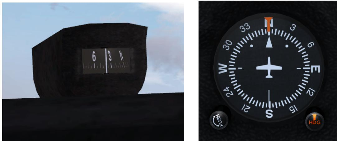
FIGURE 8.28 – Compas magnétique et gyro directionnel (également appelé « gyro compas », « plateau de route » ou « conservateur de cap »)
