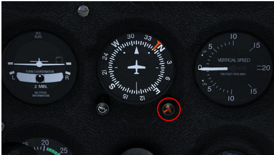
FIGURE 9.9 – Bouton de sélection de cap
