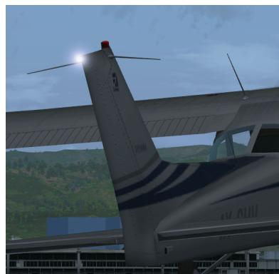
FIGURE 8.20 – Empennage et gouverne de direction
