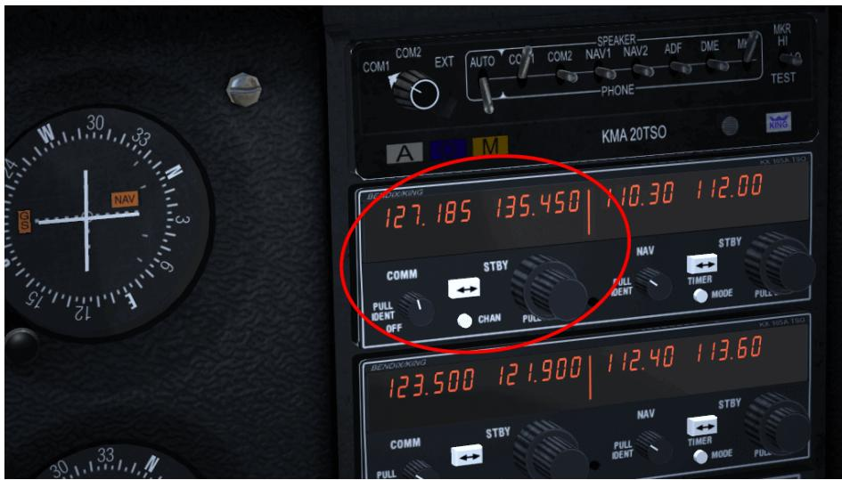
FIGURE 9.4 – Émetteur-récepteur de communication du C172 avec COMM1 entouré
