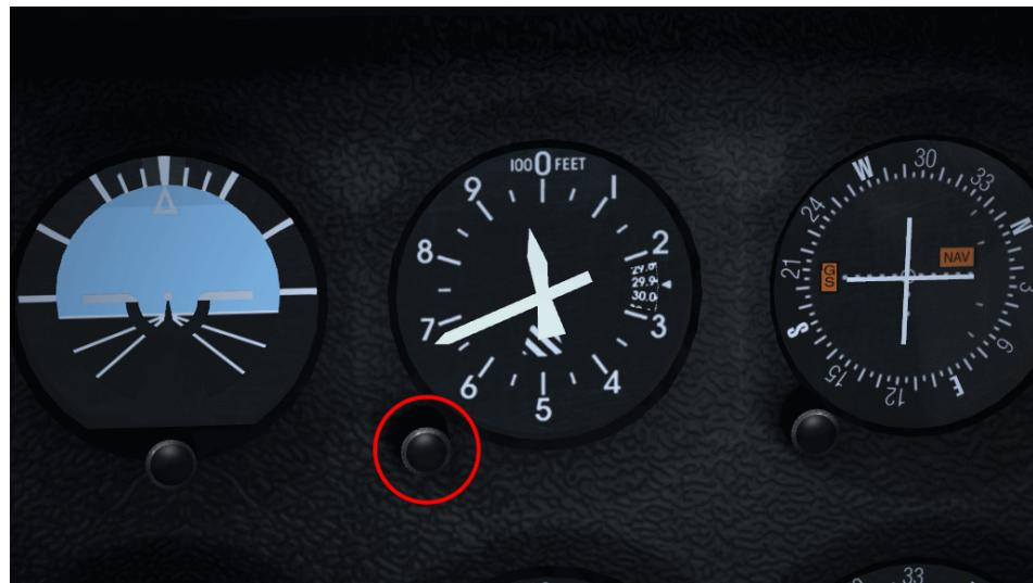
FIGURE 9.8 – Bouton de réglage de l’altimètre
