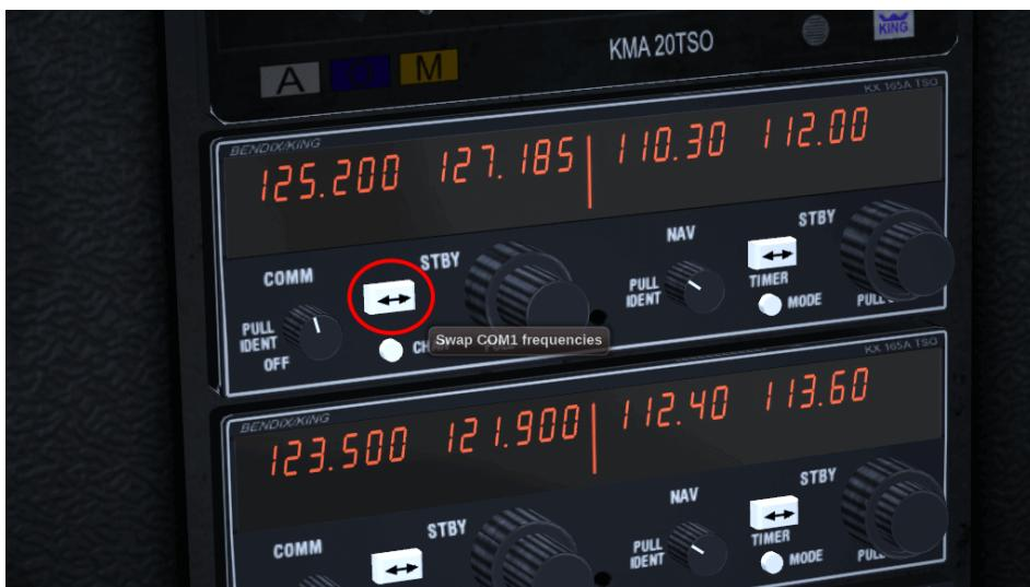
FIGURE 9.6 – Poussoir de transfert de fréquence de communication COMM1 (pour permuter les fréquences)
