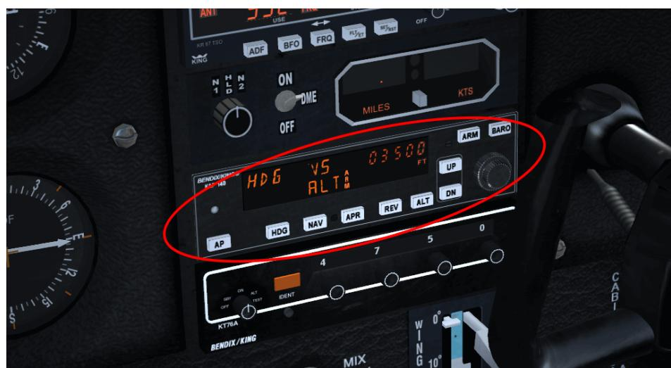
FIGURE 9.11 – Pilote automatique du C172
