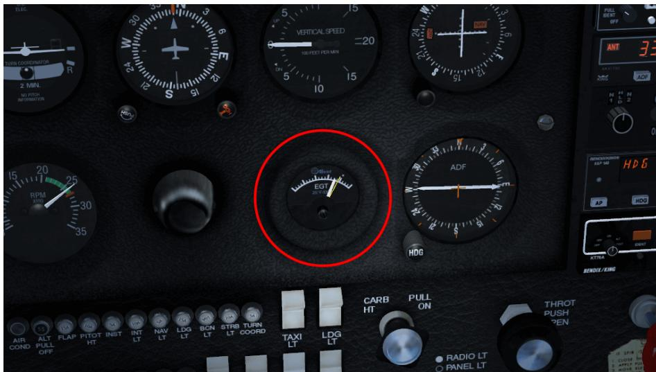
FIGURE 9.15 – L'indicateur EGT (*Exhaust Gas Temperature* – température des gaz d'échappement)
