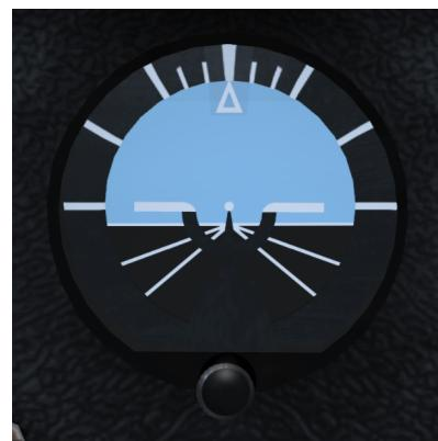
FIGURE 8.29 – L'horizon artificiel
